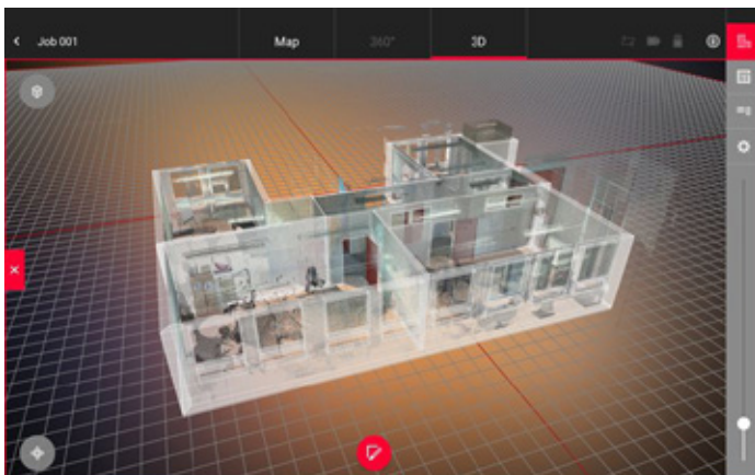
Mobilna aplikacija Cyclone FIELD 360 s prikazom oblaka točk in 3D modela (levo) ter s prikazom načrta in lokacij skenerja (desno)
