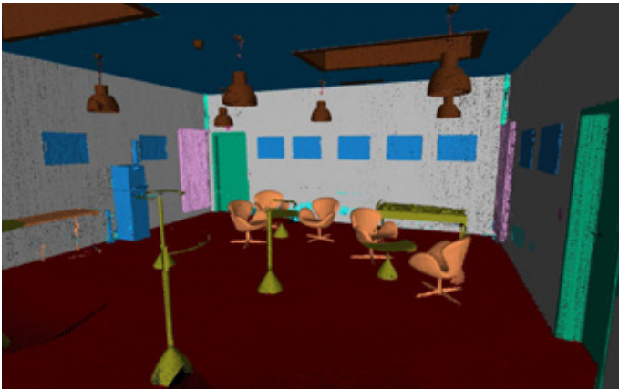
Samodejna klasifikacija 3D skena, izvedena s pomočjo Cyclone REGISTER 360 PLUS
